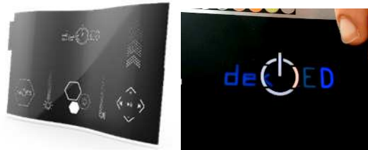
Abbildung 2: Projektdemonstrator mit integrierter OLED und Touchbedienung im Tagdesign (links) und beleuchtetem Schriftzug im Nachtdesign (rechts)
