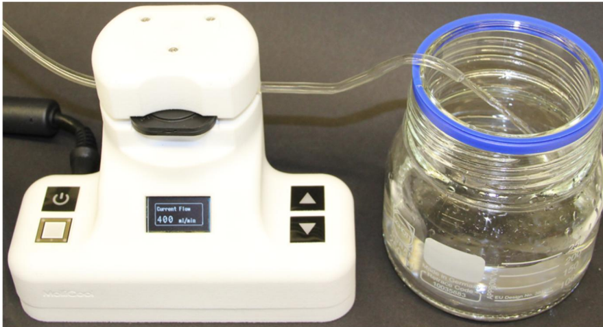
Abbildung 7: Antriebseinheit für magnetisch angetriebene Zahnradpumpe als Demonstrator
