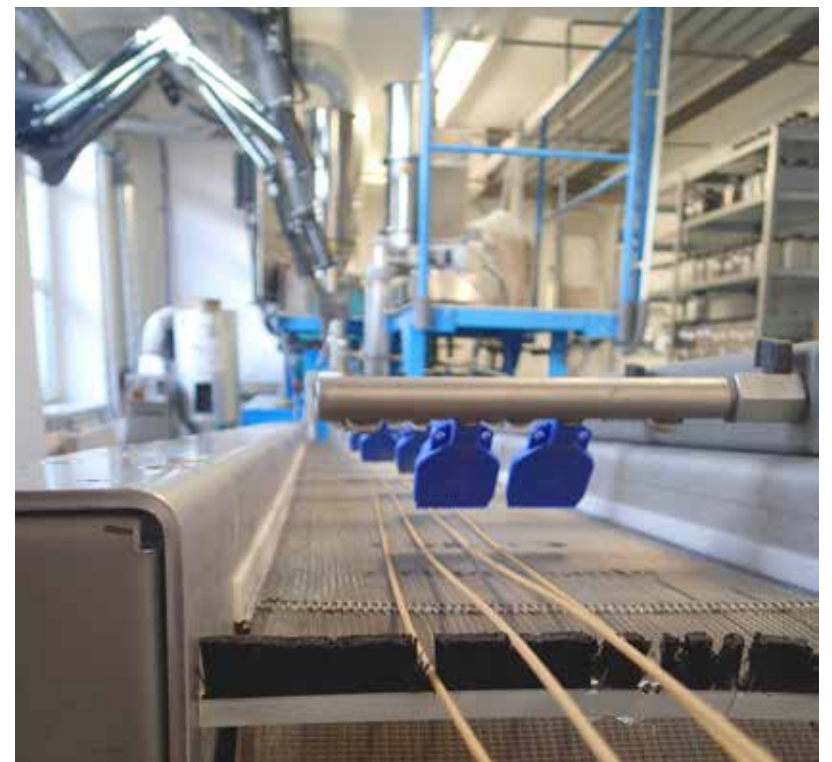
Polymerstrang auf dem Bandförderer vor Granulator
