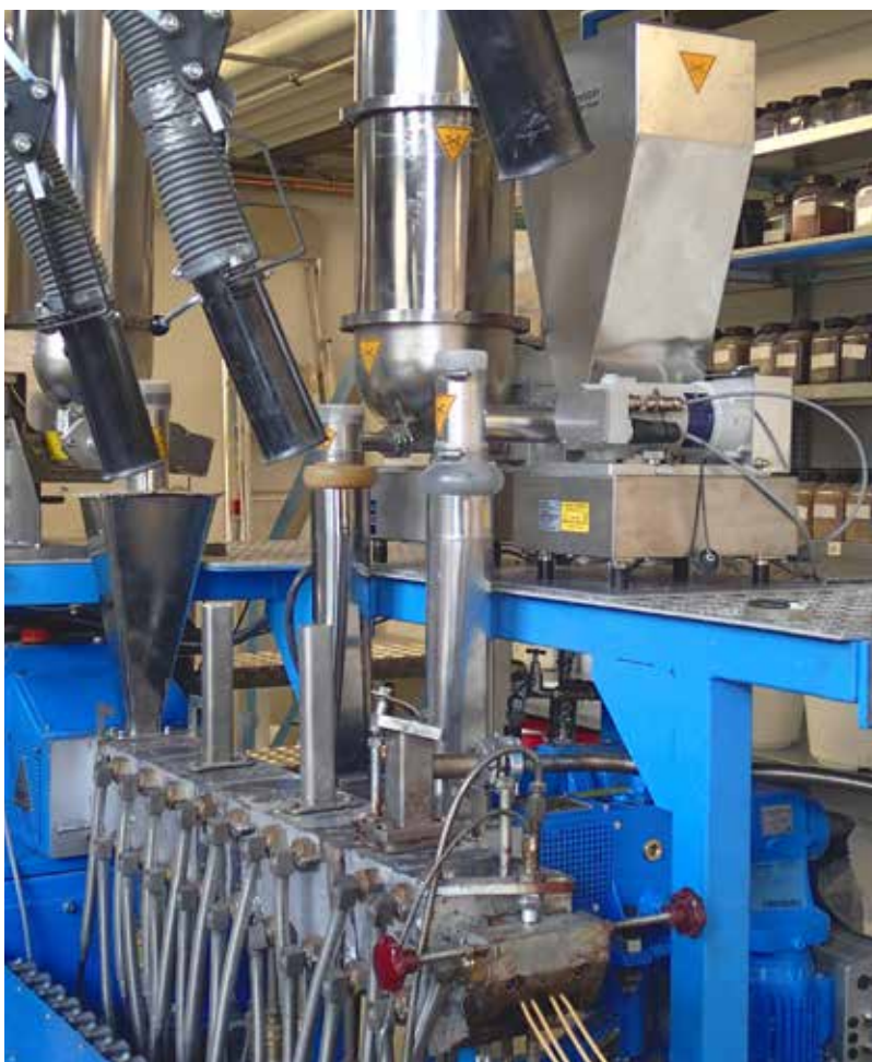
Extruder mit je drei Zylinderöffnungen zum Dosieren und Entgasen
