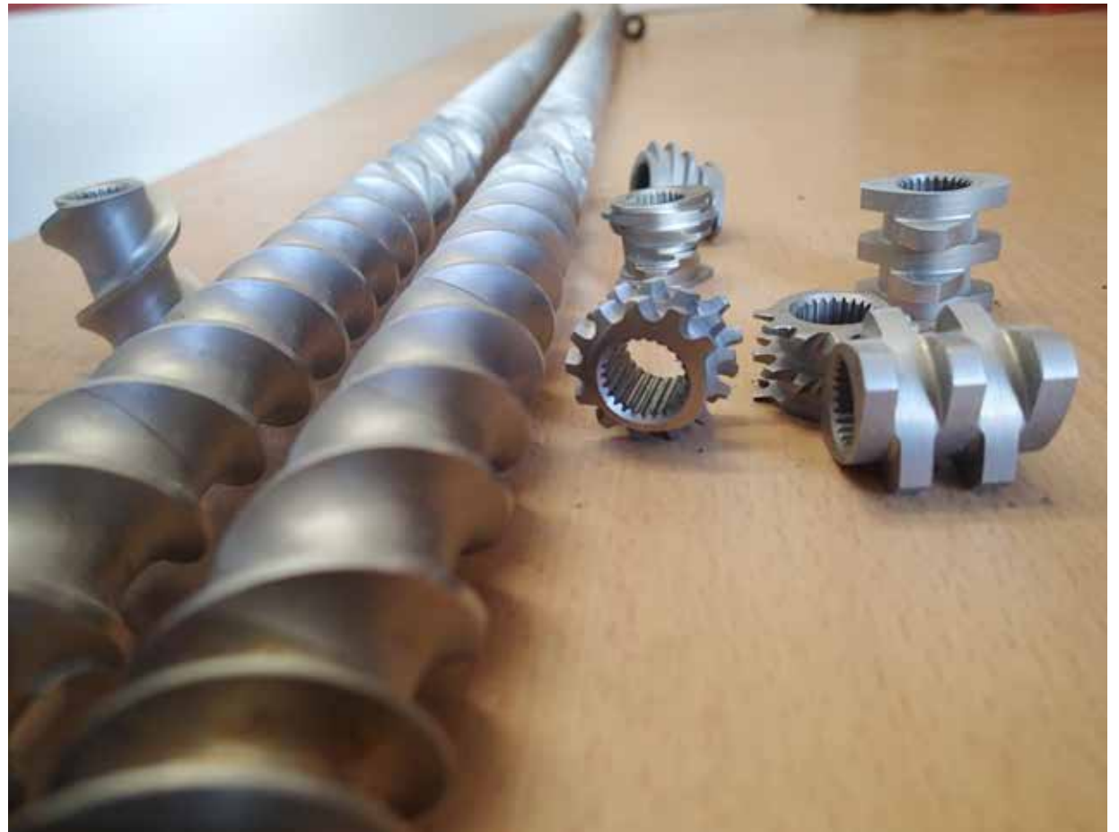
Modular aufbaubare Schnecken mit verschiedenen Elementen
