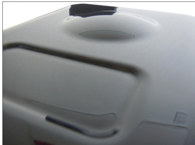
Umgeformtes Glas mit einem direkthaftenden Kunststoff (Spritzgießfähig) vergossen
