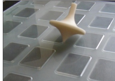
Präzise umgeformtes Glas. – In einem Toleranzbereich von <math><100\mu\text{m}</math>
