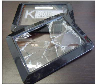
Im Thermoplastschaum-spritzguss umschäumtes Glas
