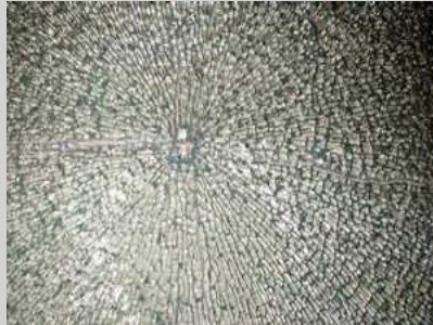
Bruchbild eines Einscheibensicherheitsglases
