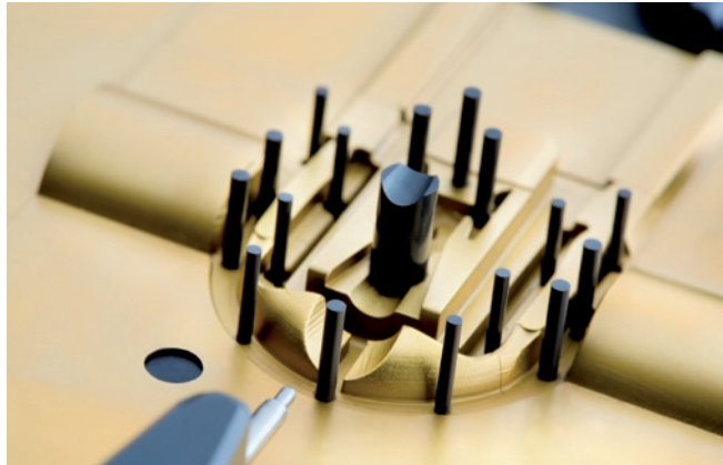
Abb. 1: DLC- beschichtete Werkzeugkomponenten [Quelle: Oerlikon Balzers Coating Germany GmbH]
