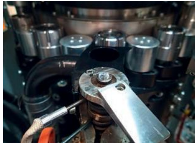
Abbildung 1: Extrusionsdüse (Vordergrund) und Werkzeugkarussell
