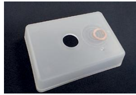
Rheologische Simulation des RFID-Demonstrator Werkzeugs (links), Demonstratorbauteil mit RFID Tag (rechts)
